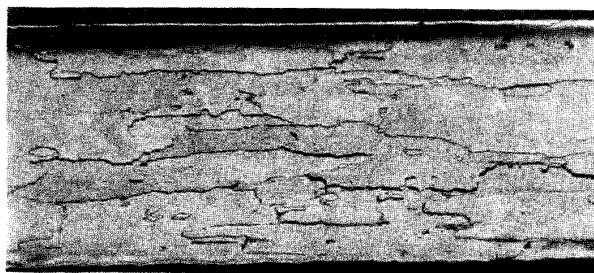
图 2 WAL2 \phi 0.4 mm 钨丝金相组织(放大 100 倍)
